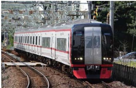
中部国際空港の開業に合わせ2004年に登場した2200系の増備車で、2015年に登場しました。外観上、窓下に赤帯が追加、スカートの形状変更、方向幕が全てフルカラーLED式に変更された点が目立ちます。特別車(1号車)の車体側面窓配置は山側が1次車と同形状、海側が2次車と同形状と、3次車固有の特徴となっています。
